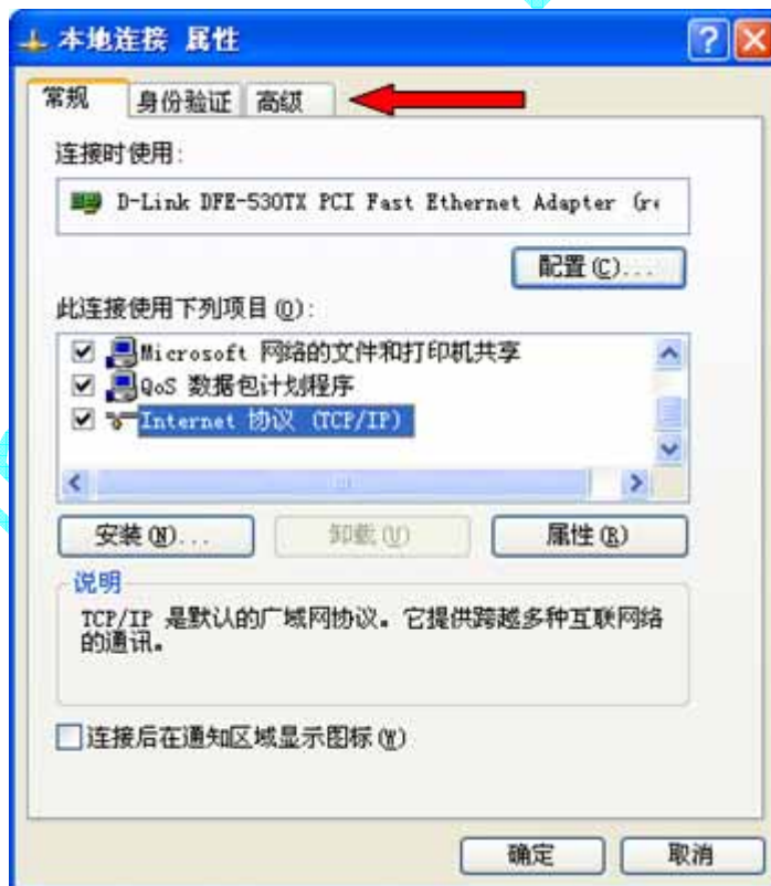
3.4.6- 这是连接的高级属性。请清除 '通过限制或阻止来自 Internet 的对此计算机的访问来保护我的计算机和网络' 复选框。现在 mIRC 就可以正常运行了。
